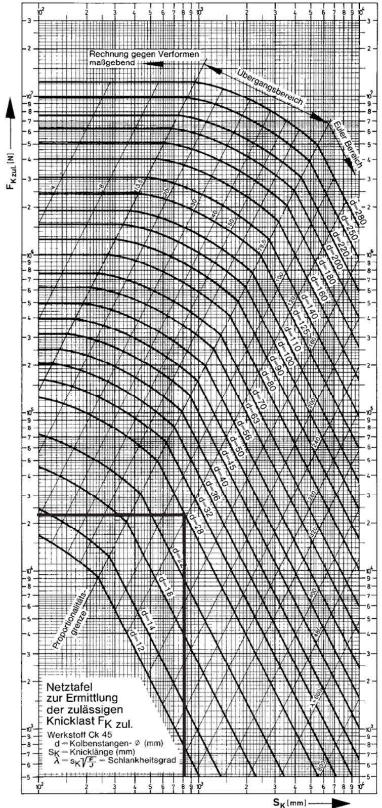
Knicklastdiagramm gilt nur für senkrechten Zylindereinbau und zentrisch eingeleitete Kraft (ohne Biegemomente oder Querkräfte)!
